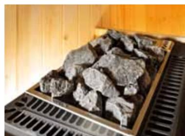
Stufa elettrica a doppia intercapedine, realizzata in acciaio smaltato e con griglia di protezione, completa di pietre. Le pietre peridotitiche permettono una distribuzione "morbida" del calore e mantengono il calore anche in caso di sbalzi dovuti all'apertura della porta.
